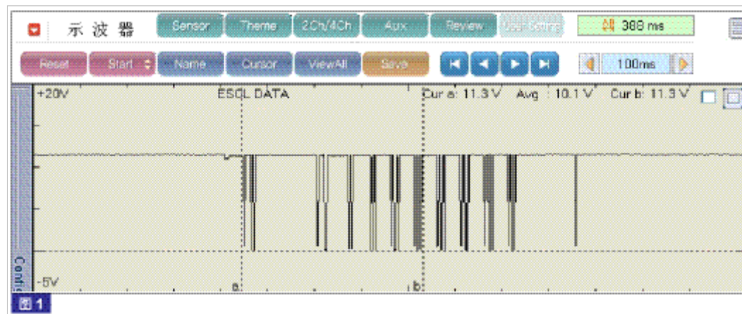
图1) ESCL 数据信号波形。
