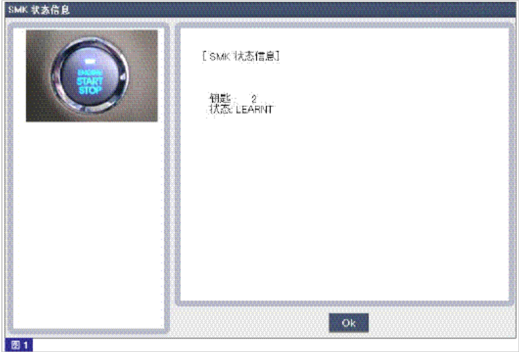
图1) 显示已注册两个 FOB 钥匙,智能钥匙 ECM 为记忆状态。
