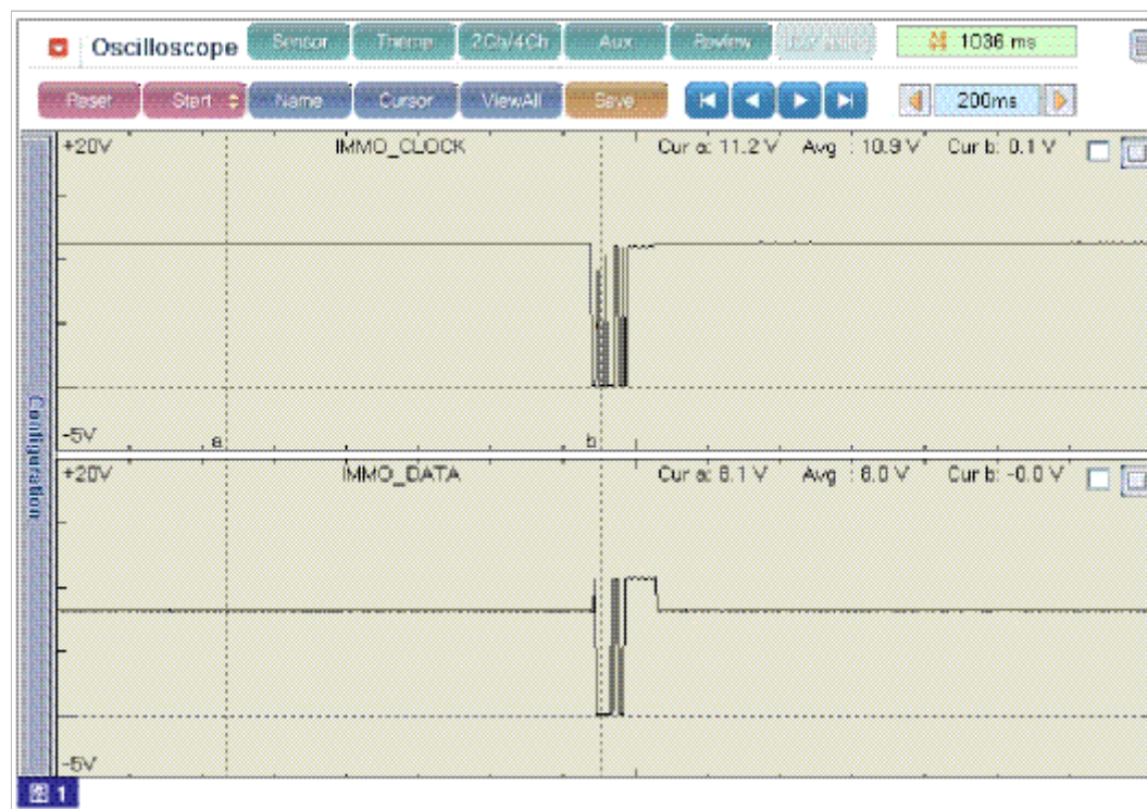
图1) 钥匙防盗系统_时钟与钥匙防盗系统_数据信号波形。
