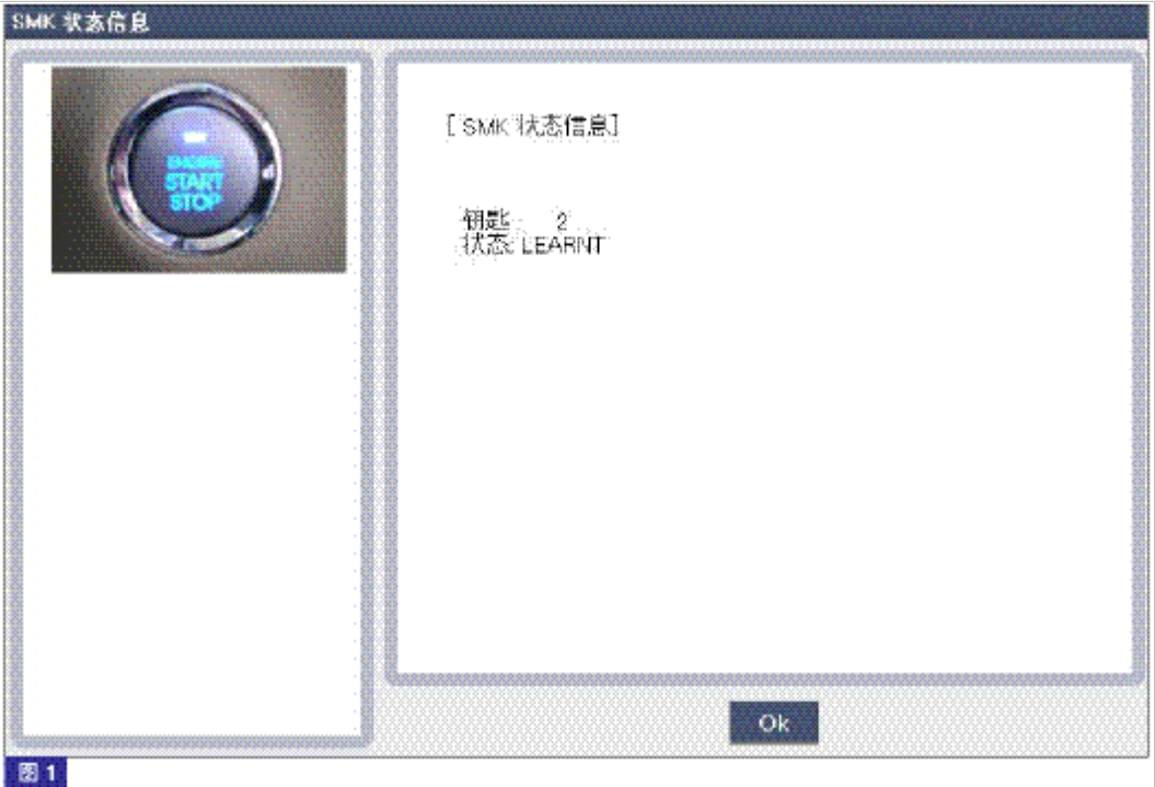
图1) 显示已注册两个 FOB 钥匙,智能钥匙 ECM(安装在IPM内)为记忆状态。
